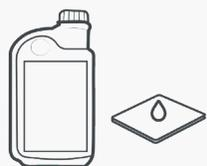
1 - À l'aide d'une compresse imbibée de la solution diluée à 0,5% d'Aniosyme X3, nettoyer le dispositif jusqu'à disparition complète des souillures/salissures, en insistant particulièrement sur les parties en contact avec le patient.
