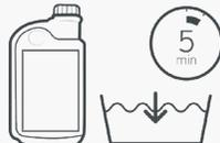
**3** - Immerger le dispositif [mais pas le(s) connecteur(s)] dans un bac contenant une solution diluée à 0,5% d'Aniosyme X3 et laisser tremper 5 minutes.
