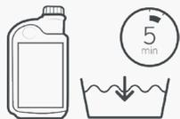
**1** - Immerger le dispositif (mais pas le connecteur) dans un bac contenant une solution diluée à 0,5% d'Anio-syme X3 et laisser tremper 5 minutes.
